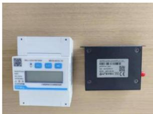
电能表、物联网关
